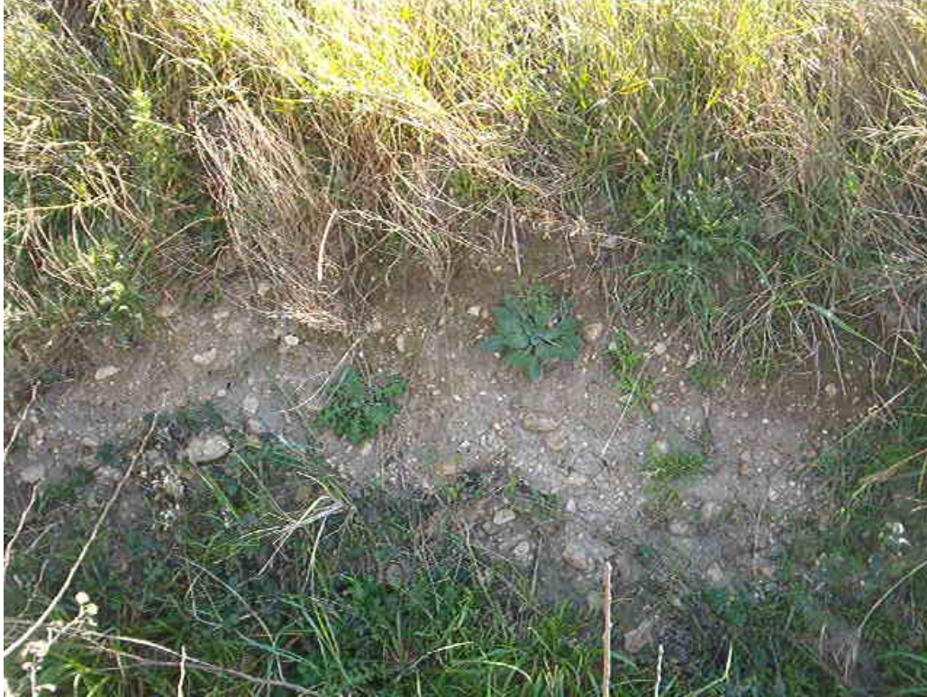
Foto 3: ciottoli inglobati in matrice limoso-sabbiosa (depositi fluviali terrazzati)
